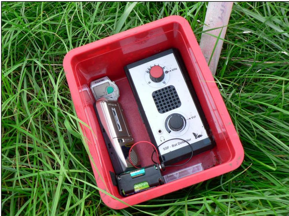
Abb. 1: Beispiel für den Aufbau einer Horchkiste
